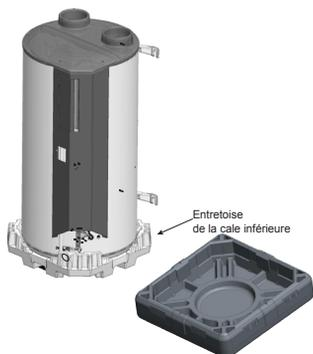
La cale inférieure du chauffe-eau est séparée en 2 parties : l'entretoise permet de protéger les piquages et le capot inférieur.
