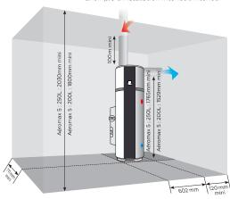
Exemple d'installation gainage extérieur/extérieur
