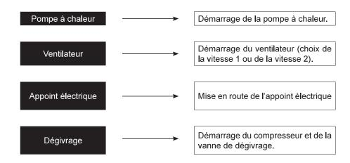
Le compresseur démarre après 30 secondes de ventilation, si les conditions suivantes sont remplies :
